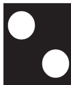
Figur 5c Betydelse: Rörelse tillåten, växel ligger i vänsterläge.
