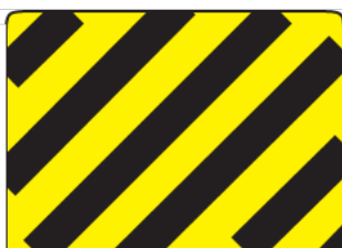
Figur 41 Skyddsutrymme saknas Betydelse: Klämrisk I gatuspår kan skylten kompletteras med texten "Klämrisk".
