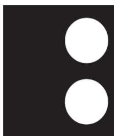
Figur 5b Betydelse: Rörelse tillåten, eventuell växel ligger i rakspårsläge.
